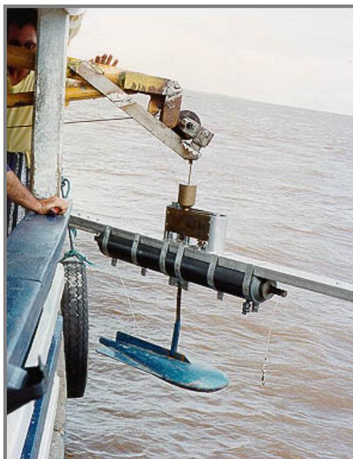
Figura 4.16 – Coletor de amostra d'água (Projeto Hibam)
